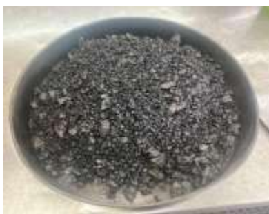
Fig. 30. 100% RAP y emulsión en mezcla asfáltica.
