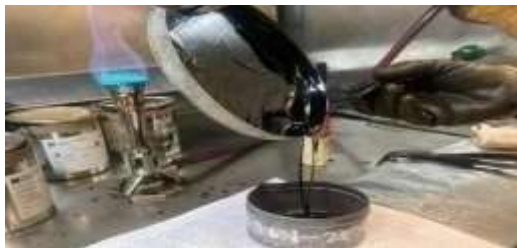
Fig. 21. Obtención de cemento asfáltico envejecido.
