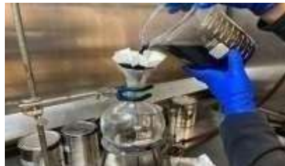
Fig. 11. Filtrado de la extracción del RAP.
