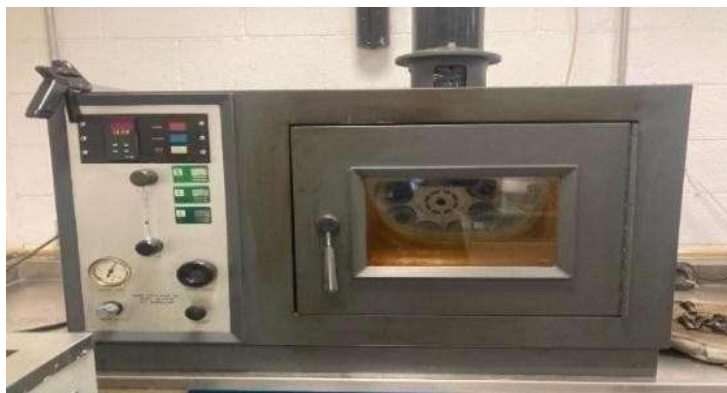
Fig. 16. Envejecimiento del residuo asfáltico en el RTFO.
