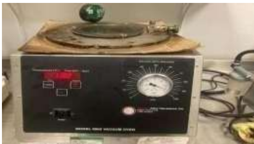
Fig. 22. Muestras envejecidas en Horno de Vacío.
