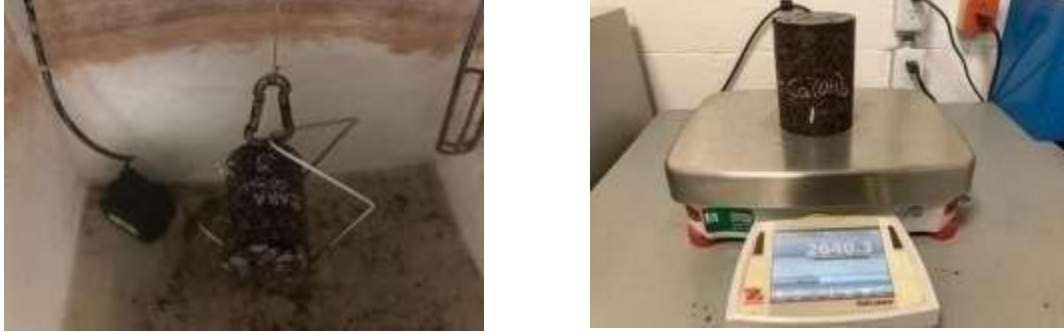
Fig. 47. Especímenes realizándose volumetría
