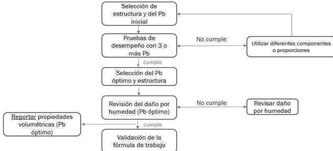
Fig. 6. Diagrama del diseño balanceado con enfoque en diseño por desempeño. Fuente: Yin, 2021.
