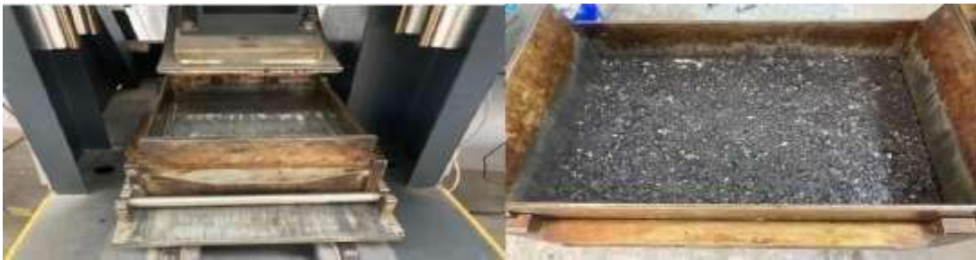
Fig. 54. Colocación de mezcla asfáltica en el compactador lineal.
