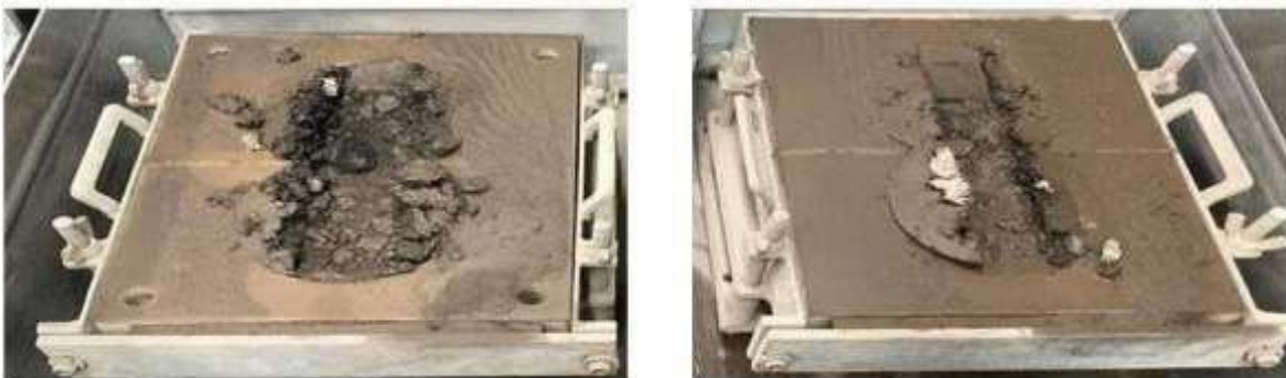
Fig. 65. Especimen izquierdo y derecho de la Prueba de Rueda Cargada de Hamburgo
