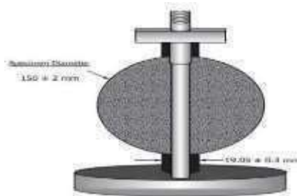
Fig. 38. Equipo de prueba de tensión indirecta tradicional.
