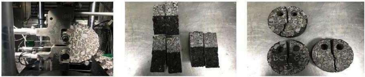
Fig. 89. Espécimen DCT, Plano de Falla y Agrietamiento
