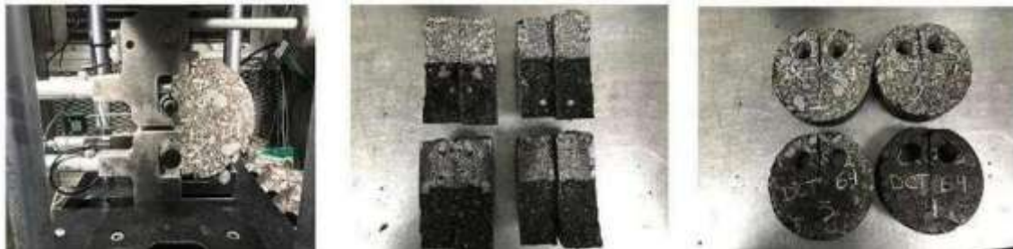
Fig. 92. Especimen en DCT, Plano de falla y Agrietamiento
