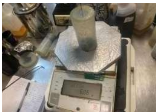
Fig. 13. Vertimiento de asfalto a recipiente RTFO.
