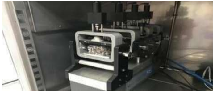
Fig. 59. Prueba de Fatiga en Viga de 4 Puntos.
