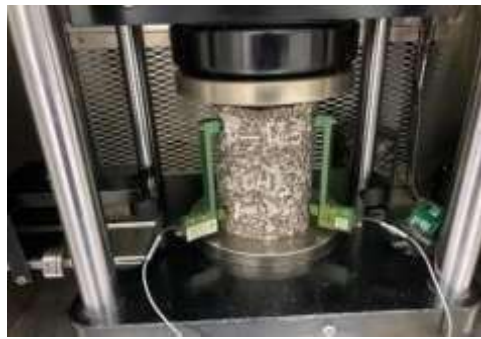
Fig. 50. Especimen con LVDT para la prueba.
