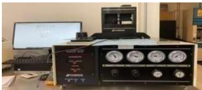
Fig. 25. Equipo de Reómetro de Viga de Flexión (BBR).
