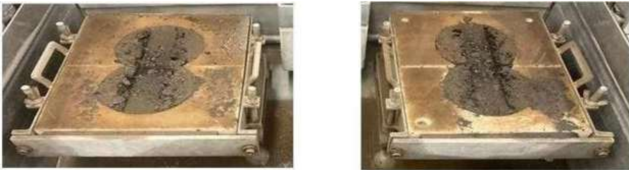
Fig. 63. Especímen izquierdo y derecho de la Prueba de Rueda Cargada de Hamburgo
