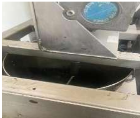
Fig. 34. Mezclado del RAP con emulsión.
