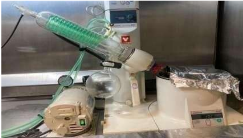
Fig. 12. Proceso de la concentración del asfalto extraído del RAP.
