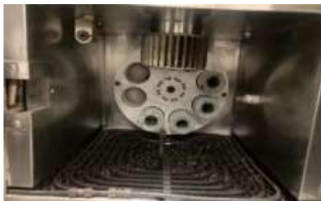
Fig. 15. Colocación de recipientes RTFO.
