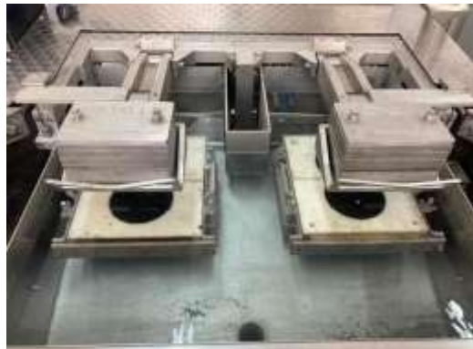
Fig. 45. Encendido de equipo de Rueda Cargada de Hamburgo
