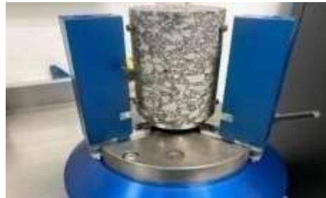
Fig. 48. Colocación de pines en espécimen.
