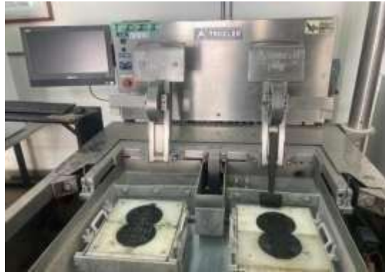
Fig. 44. Pre-acondicionamiento del equipo de Rueda Cargada de Hamburgo.
