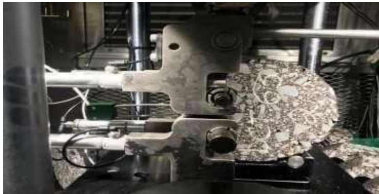
Fig. 51. Especímen en Prueba de Energía de Fractura D(CT).
