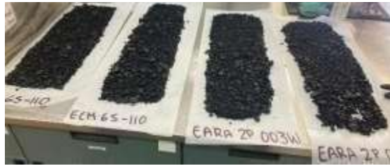
Fig. 31. Disgregación de la mezcla para Gmm.
