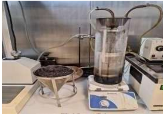
Fig. 10. Proceso de extracción del asfalto del RAP.
