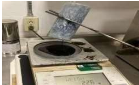
Fig. 17. Acondicionamiento de cemento asfáltico por envejecer.
