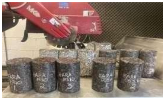
Fig. 46. Especímenes cortados para prueba de Módulo dinámico.
