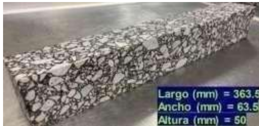
Fig. 58. Geometría para equipo de Fatiga.
