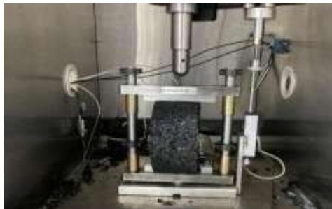
Fig. 41. Prueba de agrietamiento, "IDEAL CT".
