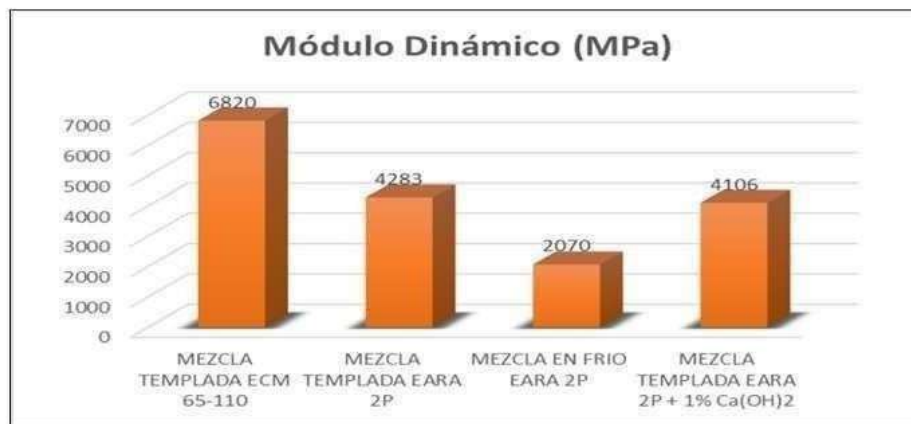
Fig. 86. Resultados de prueba de Módulo Dinámico a 20°C y 10 Hz.
