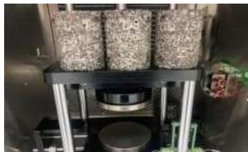
Fig. 49. Especímenes en cámara de temperatura para prueba de módulo dinámico.
