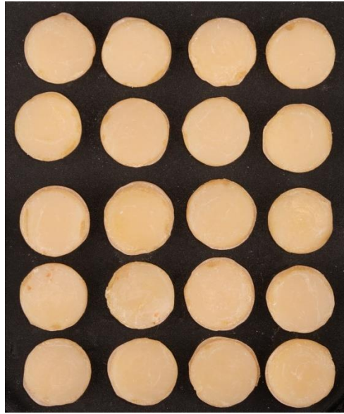
Figura 9. Discos de resina bisacrilica de Luxatemp Star posterior a la sumersión de las 3 bebidas pigmentantes.
