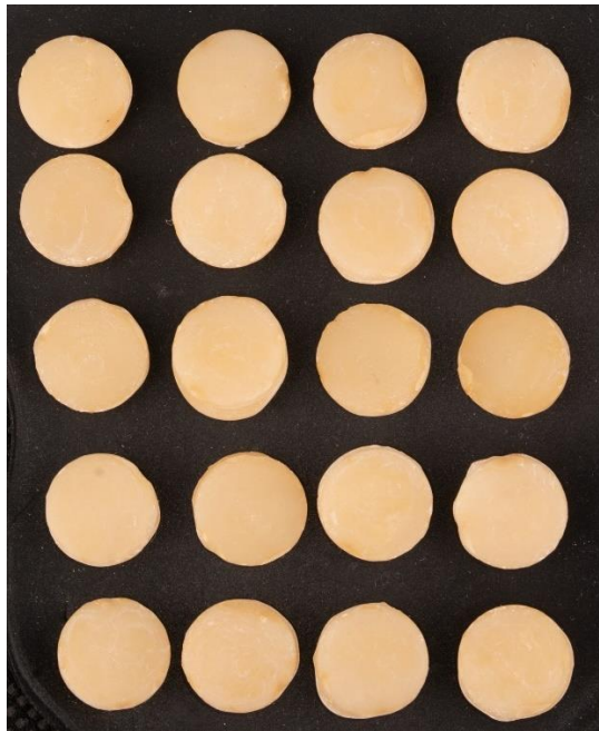
Figura 11. Discos de resina bisacrilica de Cooltemp posterior a la sumersión de las 3 bebidas pigmentantes.
