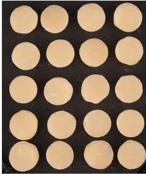
Figura 7. Discos de resina bisacrilica de Structur Premium posterior a la sumersión de las 3 bebidas pigmentantes.
