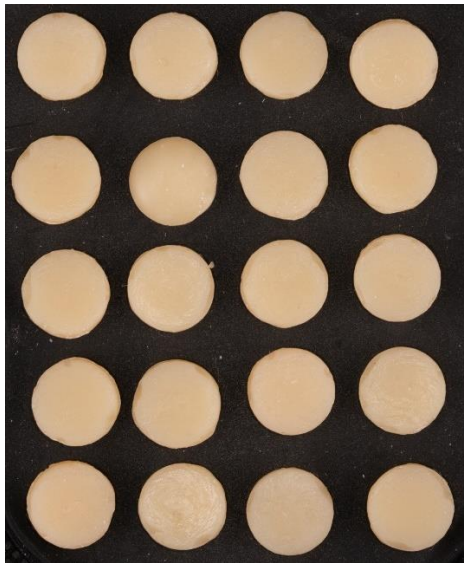
Figura 8. Discos de resina bisacrilica de Luxatemp Star previo a la sumersión de las 3 bebidas pigmentantes.
