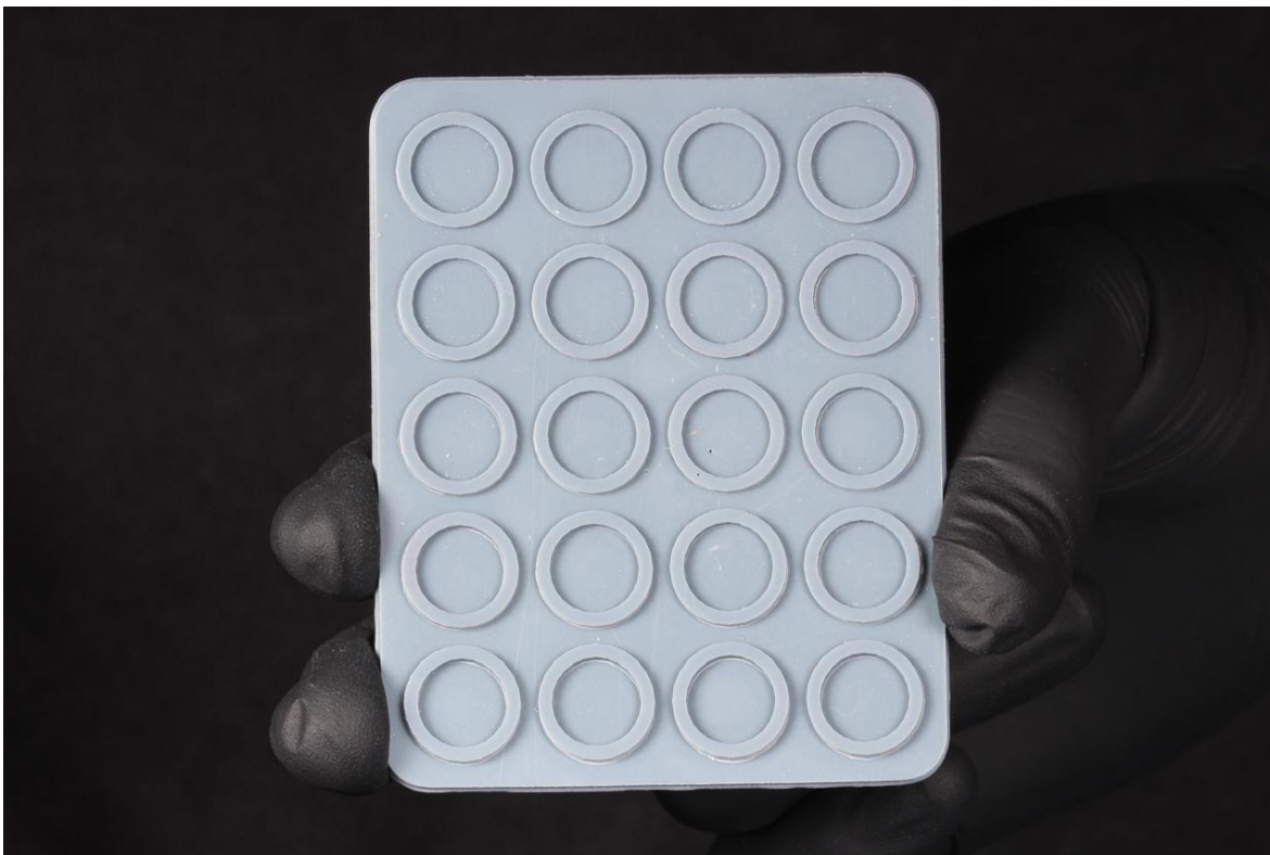
Figura 3. Figura 3. Plantilla de 20 cavidades con dimensiones de 10 mm de diámetro por 2 mm de espesor.
