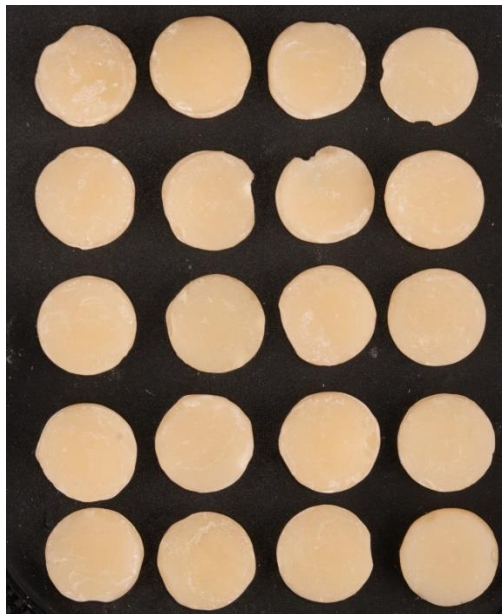
Figura 10. Discos de resina bisacrilica de Cooltemp previo a la sumersión de las 3 bebidas pigmentantes.
