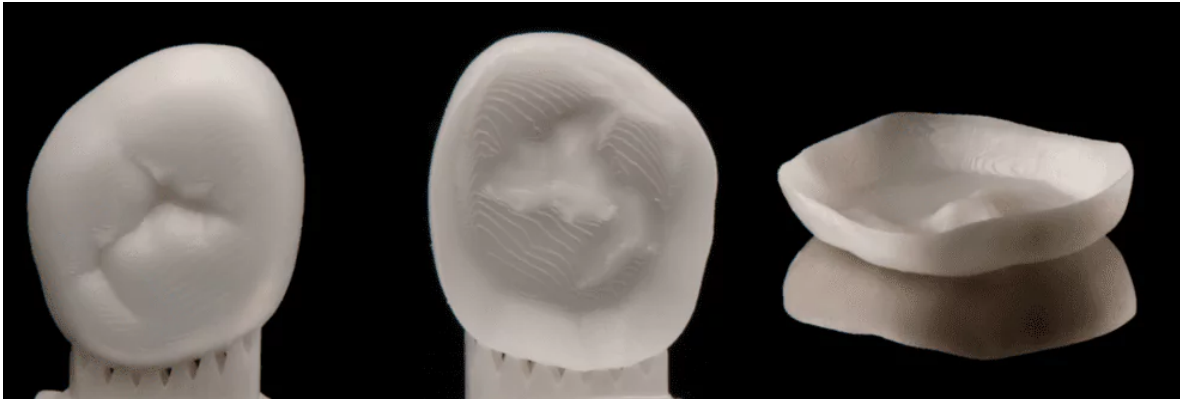
Figura 15. Restauración indirecta de zirconia elaborada mediante fabricación aditiva, como ejemplo adaptado de aplicaciones descritas en la literatura (77).
