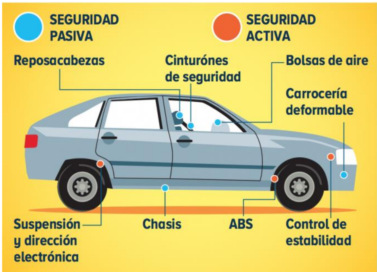
Figura 3. Seguridad pasiva y seguridad activa (Pérez, 2021)
