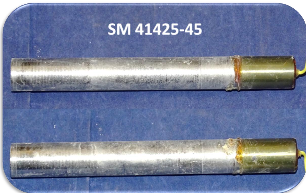
Figura 75. Condiciones finales del acero UNS 41425, relación a/c 0.45.
