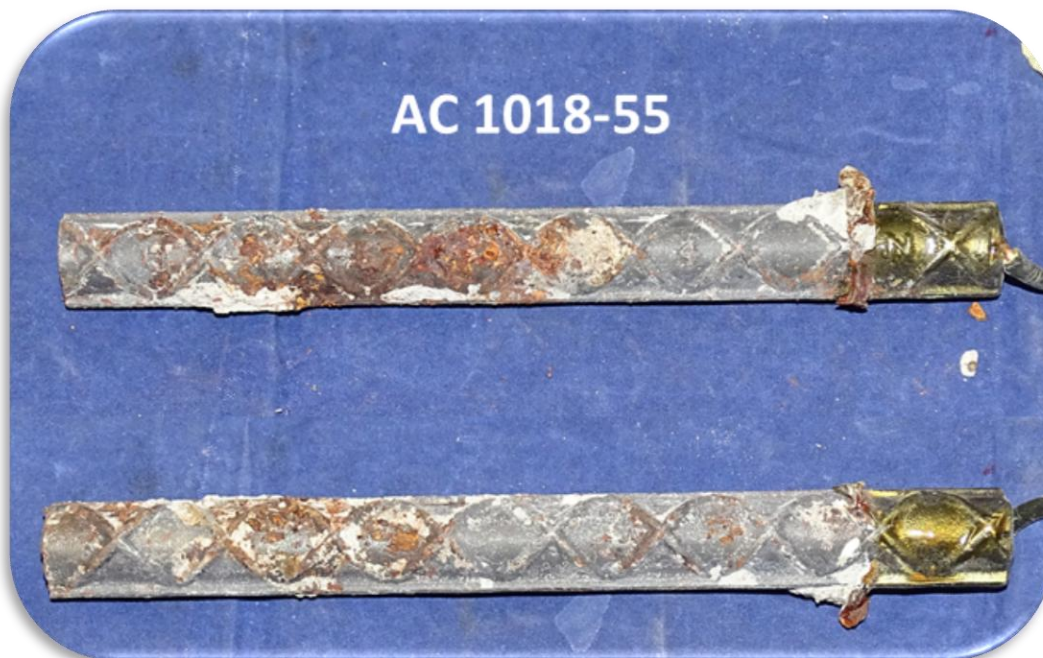
Figura 73. Condiciones finales del acero AISI 1018, relación a/c 0.55.
