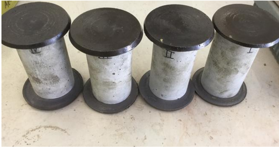
Figura 42. Cilindros de concretos cabeceados con azufre.
