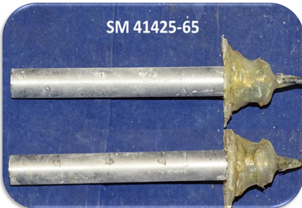
Figura 77. Condiciones finales del acero UNS 41425, relación a/c 0.65.
