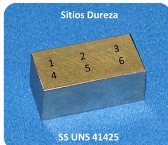
Figura 26. Sitios de dureza del acero inoxidable UNS S41425.
