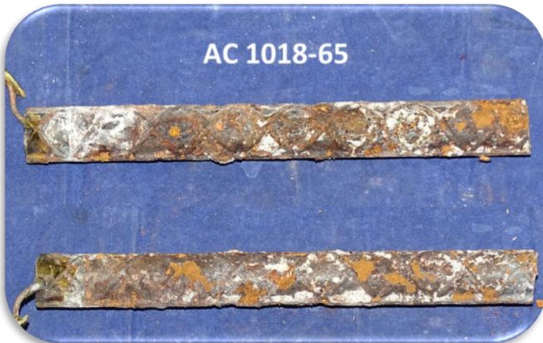
Figura 74. Condiciones finales del acero AISI 1018, relación a/c 0.65.
