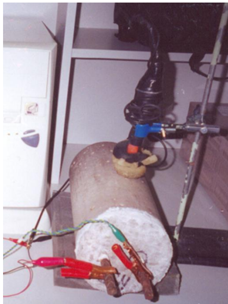
Figura 16. Conexiones con el electrodo de referencia a la estructura de concreto reforzado.
