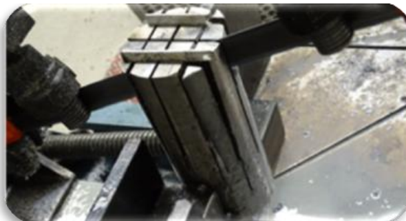
Figura 21. Seccionamiento de la barra del acero supermartensítico UNS S41425.
