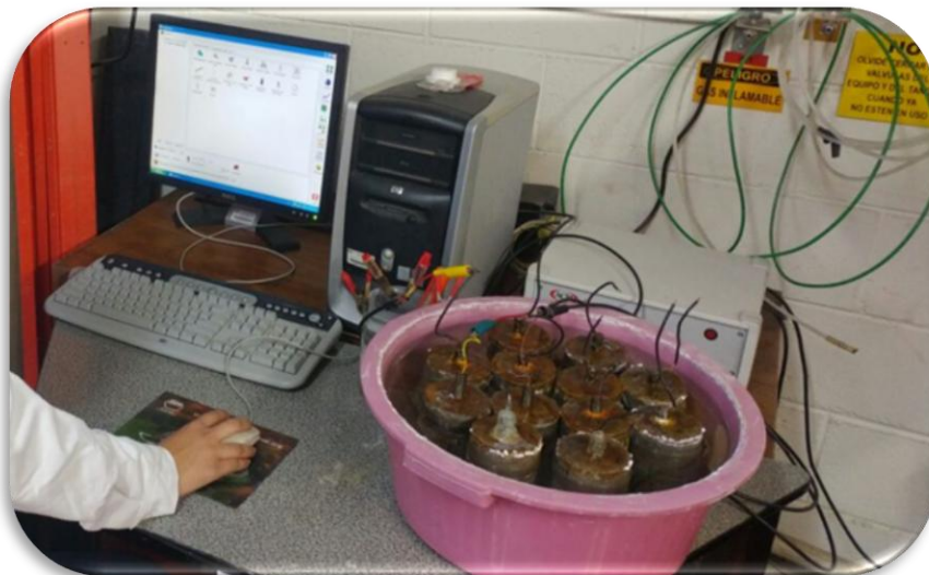
Figura 33. Monitoreo electroquímico de las muestras de acero-concreto
