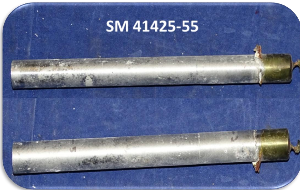
Figura 76. Condiciones finales del acero UNS 41425, relación a/c 0.55.
