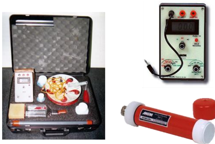
Figura 17. Equipo e instrumentos de medición para el Potencial de Corrosión
