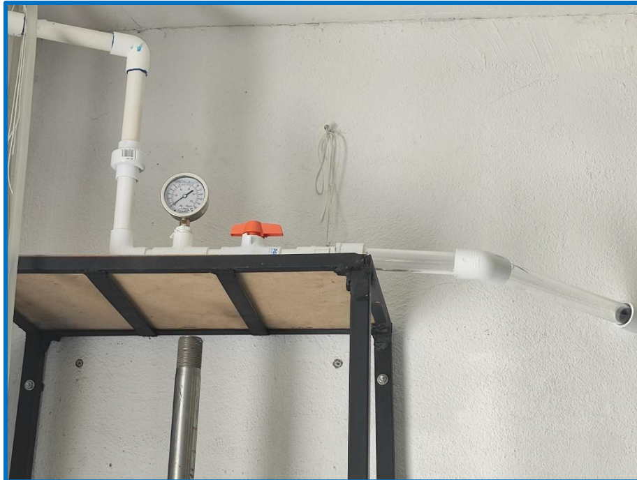
Figura 14 Válvulas y Manómetro de Entrada del Modelo Experimental
