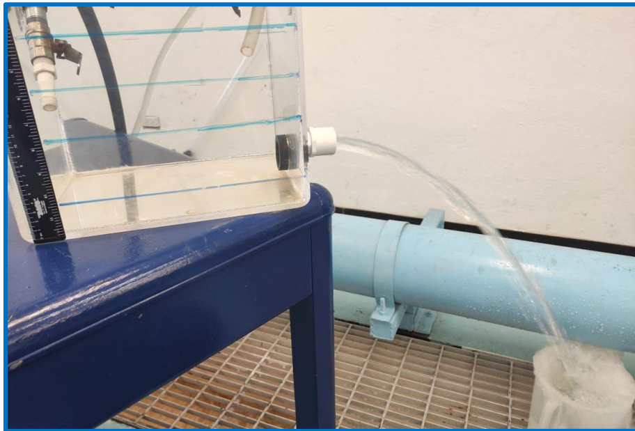
Figura 17 Conexión al Acrílico de Tubería
