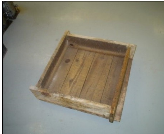
Figura 14.- Molde utilizado para elaboración de bloques de concreto en pruebas método Windsor.
