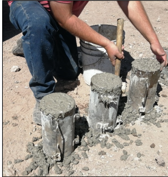
Figura 15.- Eliminación de aire atrapado en probetas cilíndricas.
