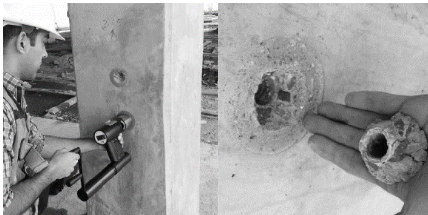
Figura 9.- Equipo moderno de prueba Pull-out para determinar la resistencia en estructuras viejas.
